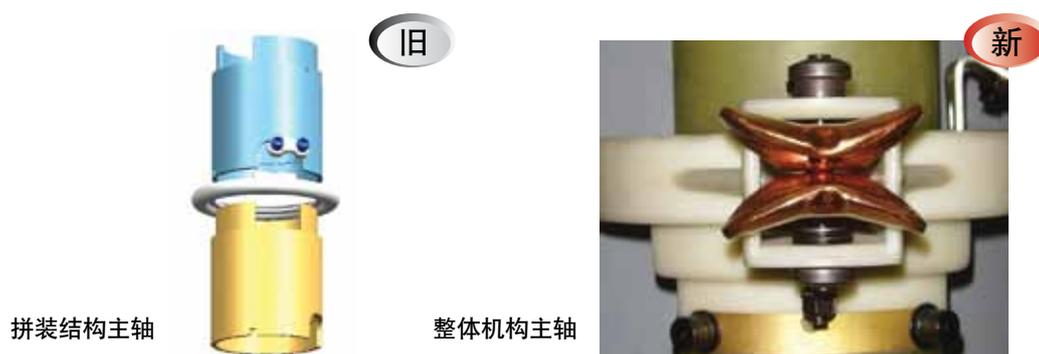
选择器中心柱由原来多级绝缘管拼装式改为整体式结构，彻底解决了由于中间轴刚性差而产生的触头动作不到位的问题。
